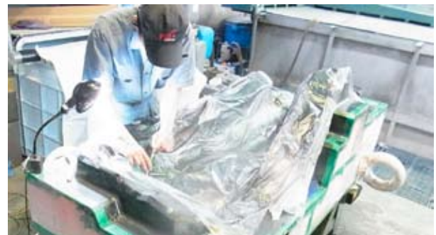
写真8 大型金型へのフィルムからのインク転写作業
