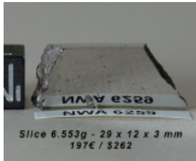
図5.天然に合成された FeNi 超格子磁石 (隕鉄)
