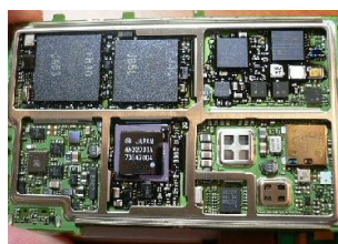
図1: 795個のセラミック電子部品が収まるスマートフォン (出所)村田製作所広報資料
