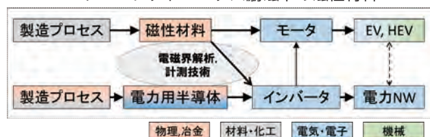
図 2. 磁性材料と電力用半導体の 材料プロセスから応用までの技術要素とその相互関係
