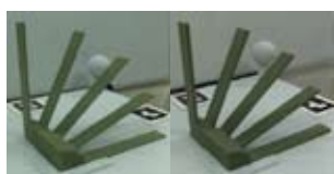
図 11 造形物評価試験片 (最小厚さ評価)
