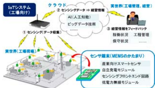
図 2 Society5.0/IoT システムで活躍する MEMS
