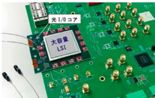
図 5. 大容量 LSI 周辺に光 I/O コアを搭載した実装ボード
