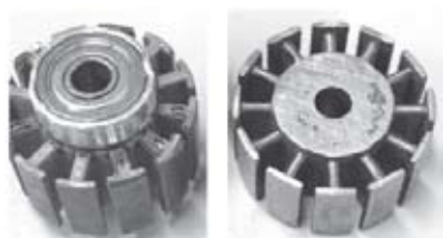
電磁鋼板積層ステータ(左)と 3Dプリンティングによる圧粉磁心ステータ(右)(BK-02)
