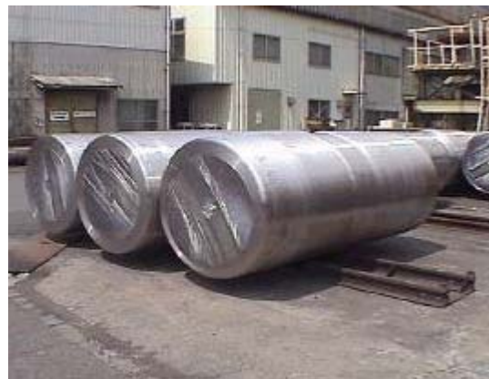
図2-2 VAR溶解炉とインゴット 2)
