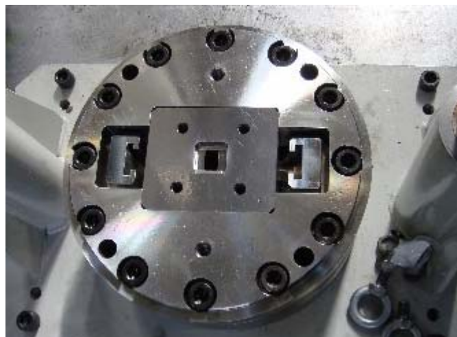
図-3.2.3 断面変化型材の外部駆動金型セットの俯瞰写真
