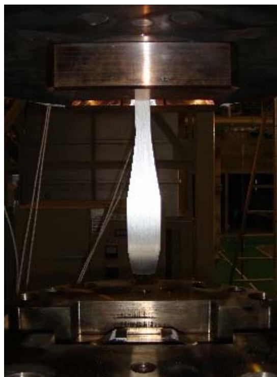
図-3.2.4 外部駆動金型セットによる断面変形状材の製作例
