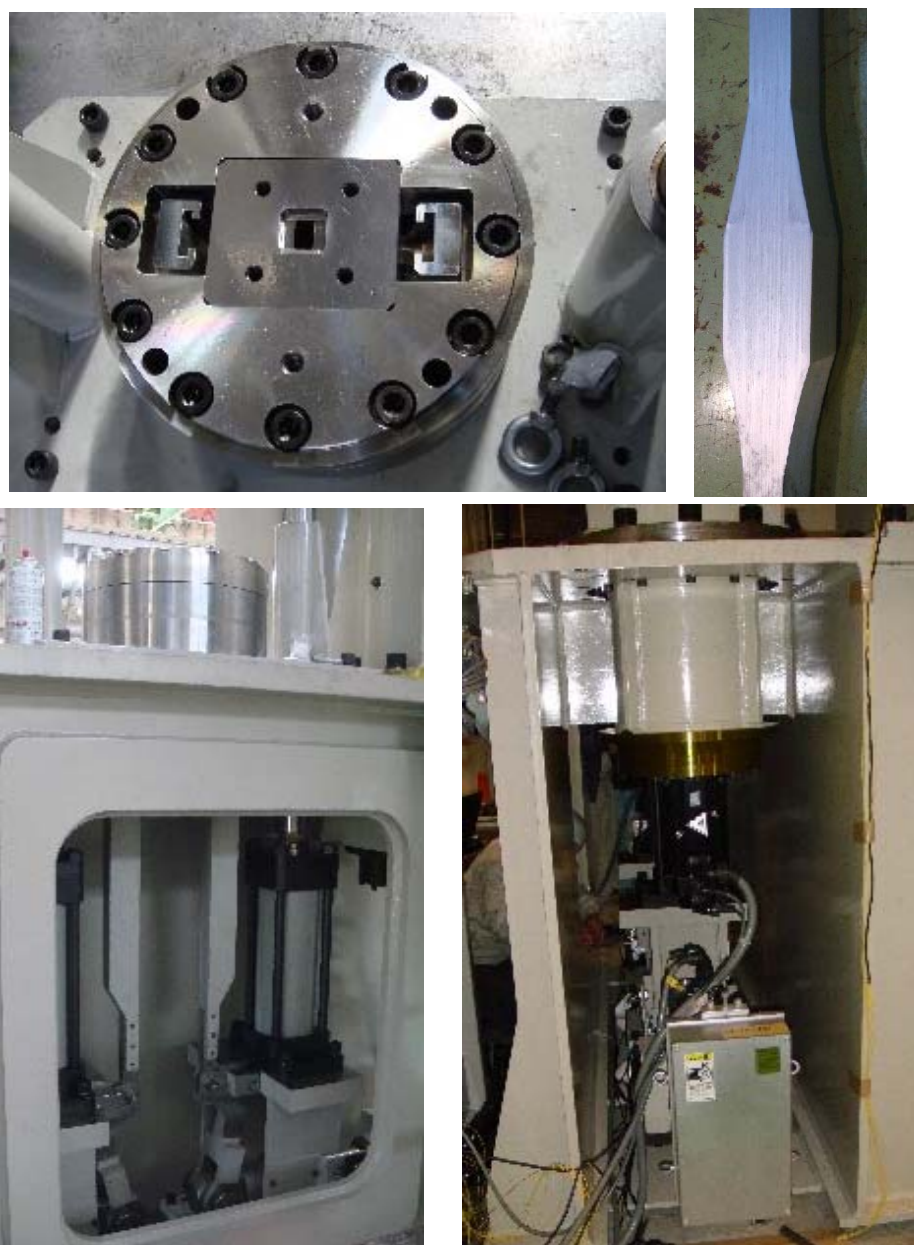
図-3.2.9 断面変化型材の外部駆動、金型、試作品
