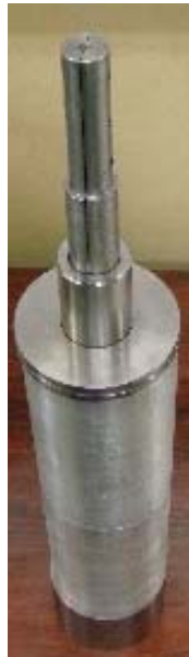
図-3.2.5 断面変化型材の内部駆動金型セットの組み立て例
