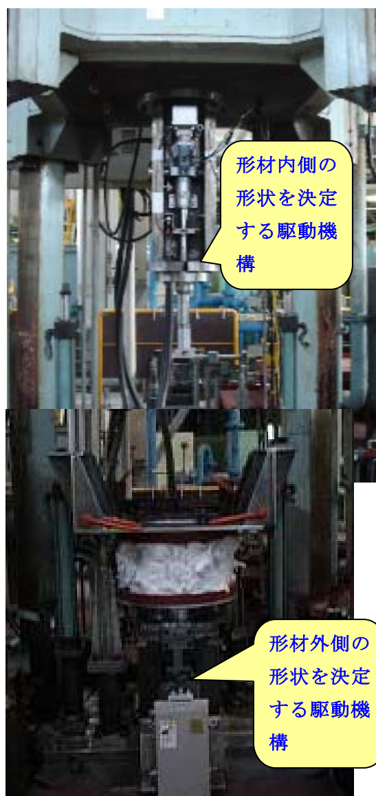
図-3.1.5 汎用プレスに実験シミュレーション装置を組み入れた状態
