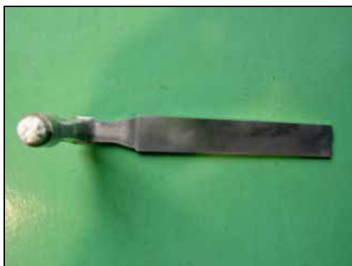
図-3.2.1-5 熊大マグネシウム合金（Mg96Y2Z2）を使用した成形品形状（150mm×25mm×t=3mm）
