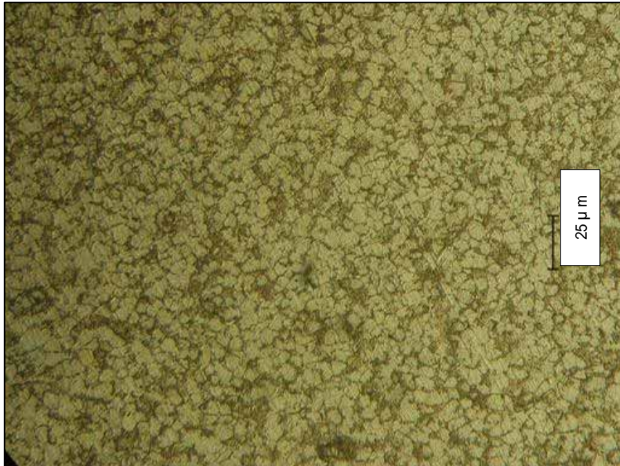
図-3.2.2-4 Mg(97.75-97.7)Zn(0.25-0.3)Gd 2 金属顕微鏡の画像 ( ×400 450 ×5h-T4 内部 )
