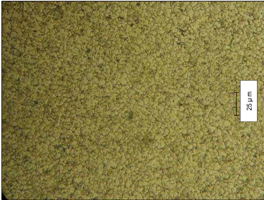
図-3.2.2-2 Mg96Y2Z2 金属顕微鏡の画像 ( × 400 450 × 5h-T4 内部 )
