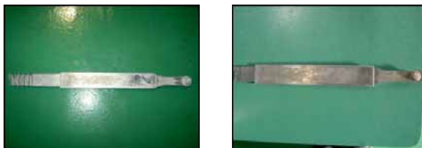
図-3.1.1-4 成形品の外観比較 (左:AZ91D、右:Mg96Y2Z2)
