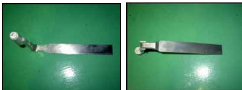
図-3.3.2-1 Mg96Y2Z2での成形品（左：表側 右：裏側）
