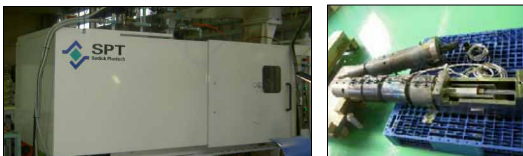
図-3.1.1-1 左：ビレット方式射出成形機 右：射出部と溶解部
