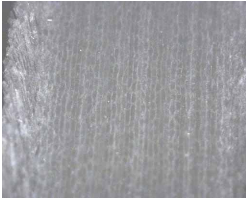
図3 - 2 - 16 送り速度2500m/min 加工面顕微鏡データ(倍率25倍) 粗さ計データ3箇所平均: Ra0.79μm
