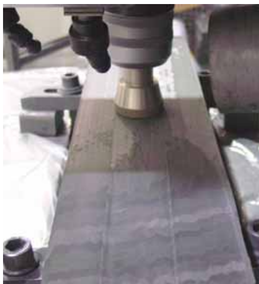
図1-1-8 ダイヤモンド工具での切削実験
