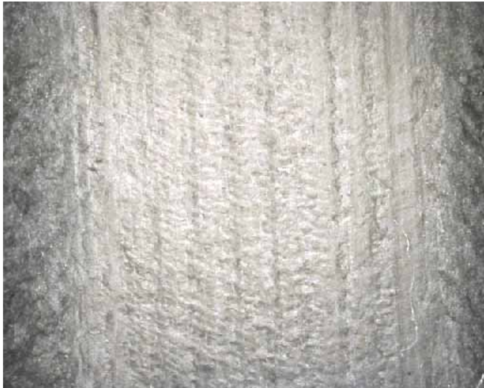
図3 - 2 - 28 90°UD材 加工面 (倍率25倍) 粗さ計データ3箇所平均: Ra 3.87 μm
