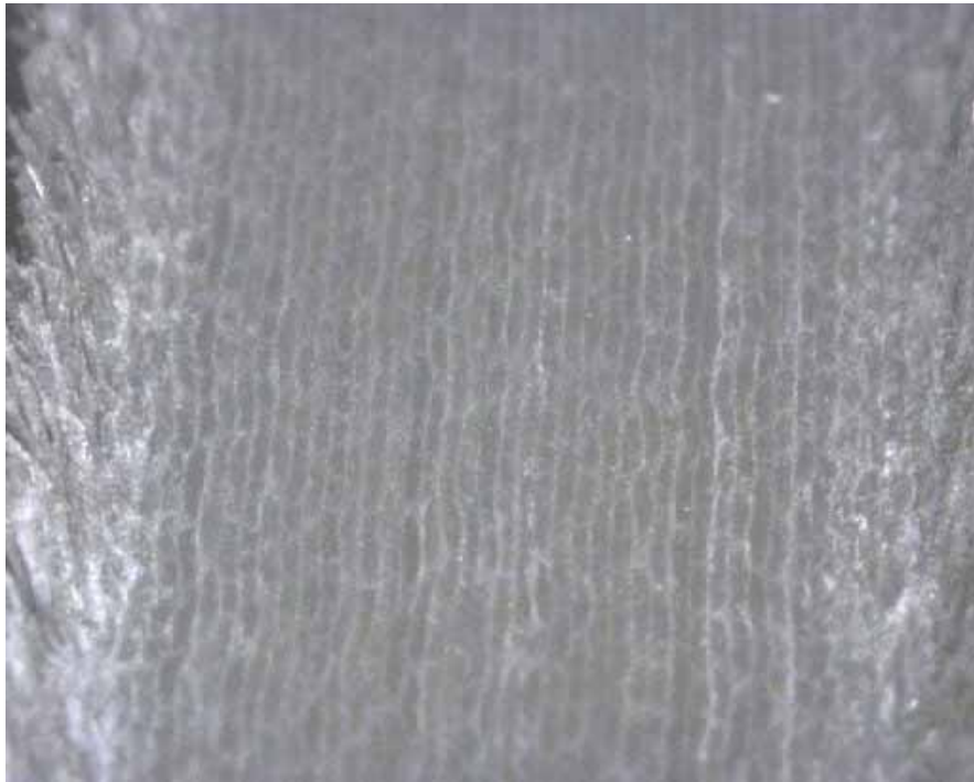
図3 - 2 - 13 60°超硬工具 加工面顕微鏡データ(倍率25倍) 粗さ計データ3箇所平均：Ra0.79μm
