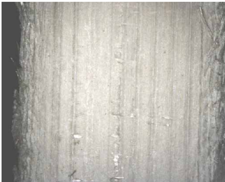
図3 - 2 - 26 45°UD材(順方向) 加工面 (倍率25倍) 粗さ計データ3箇所平均: Ra 0.79 μm
