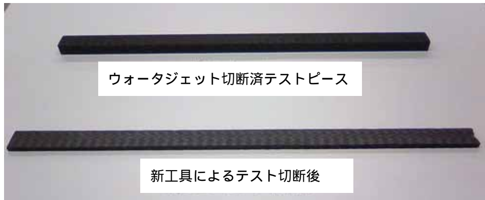
図3 - 1 - 5 ダメージ評価用テストピース形状 (写真)
