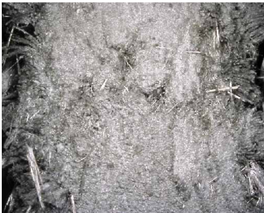
図3 - 2 - 27 45°UD材(逆方向) 加工面 (倍率25倍) 粗さ計データ3箇所平均: Ra 19.95 μm
