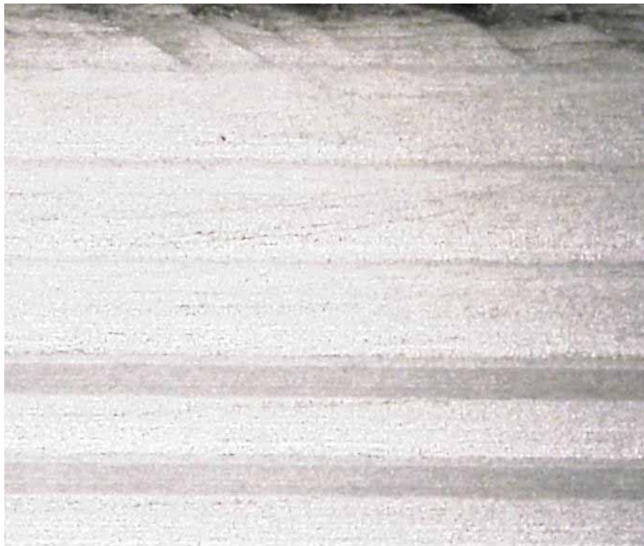
図3 - 2 - 19 45°ダイヤモンド工具(切削開始)加工面(倍率50倍)
