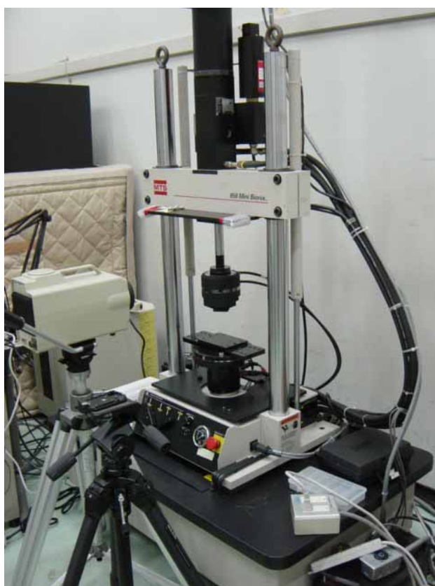
図3-2-33 赤外線サーモグラフィ試験装置及び10kN油圧制御材料試験機
